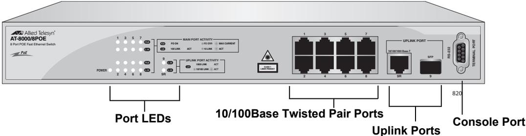
Figure 1. AT-8000/8POE Front Panel
